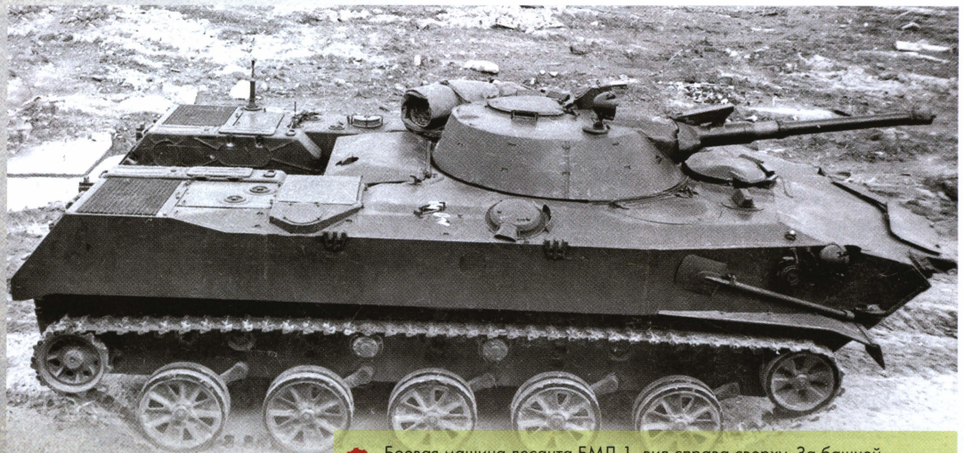
Боевая машина десанта БМД-1, вид справа сверху. За башней хорошо виден большой прямоугольный люк десантного отделения.
